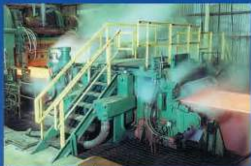
Descarepação de Chapas
