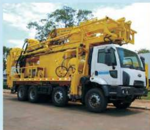
R-4HE para perfuração até 1500 m R-4HE para perforación hasta 1500 m
