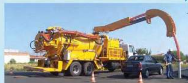
SVR-200P Sistema combinado hidrojetamento e sucção por "Roots" / SVR-200P Sistema combinado hidrojet y aspiración
