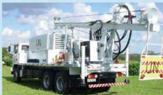
R-1SC com compressor incorporado R-1SC con compresor incorporado
