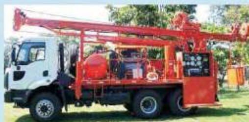
R-1HBX para perfuração até 500 m R-1HBX para perforación hasta 500 m
