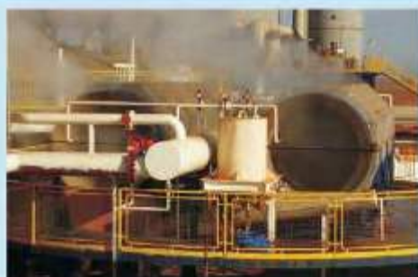
Peneira rotativa para caldo clarificado/decantado Tamiz rotativo para jugo clarificado/decantado
