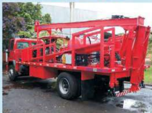
GMP-015 para manutenção de poço (15 toneladas) GMP-015 para mantenimiento de pozos (15 toneladas)
