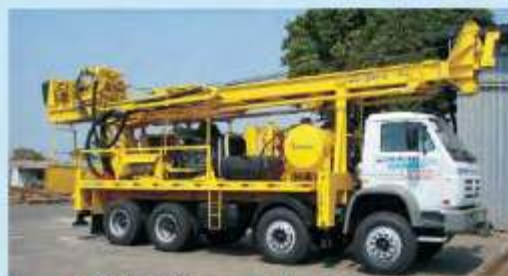
R-4H / R-4HS para perfuração até 1500 m R-4H / R-4HS para perforación hasta 1500 m
