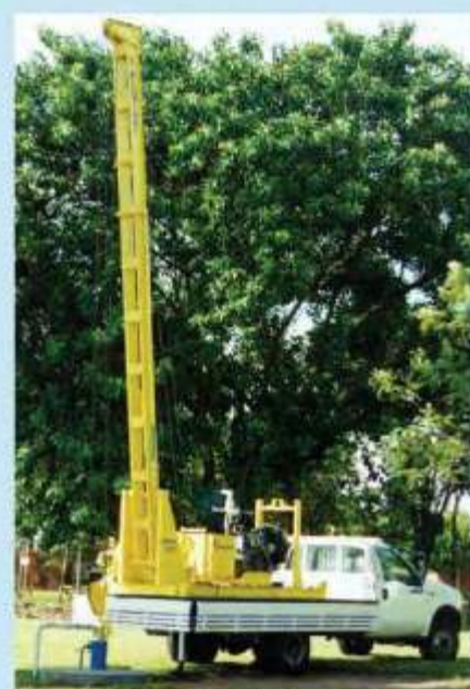
GMP-08 para manutenção de poço (8 toneladas) GMP-08 para mantenimiento de pozos (8 toneladas)
