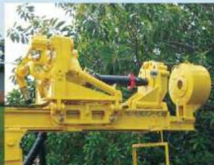
R-1HBS para perfuração até 500 m / R-1HBS para perforación hasta 500 m
