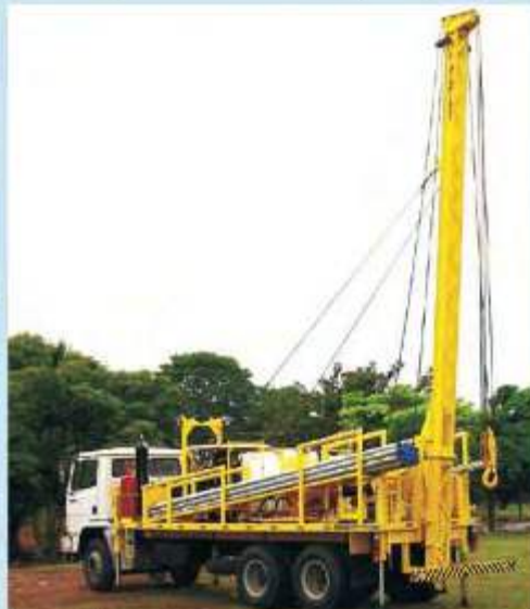
GMP-015 para manutenção de poço (15 toneladas) GMP-015 para mantenimiento de pozos (15 toneladas)
