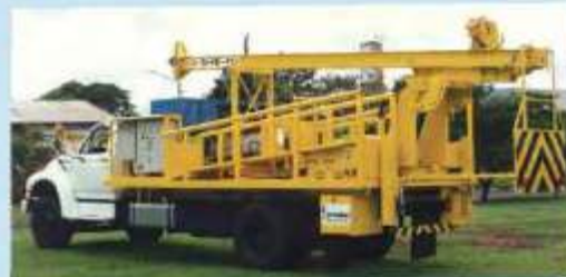
R-1ST para manutenção de poços R-1ST para mantenimiento de pozos
