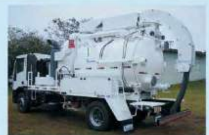
SVR-130 Sucção bomba roots SVR-130 Succión por soplador (roots)
