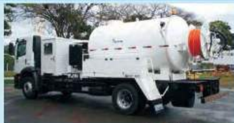
SLP-125 Limpeza por hidrojetamento SLP-125 Limpieza por hidrojet
