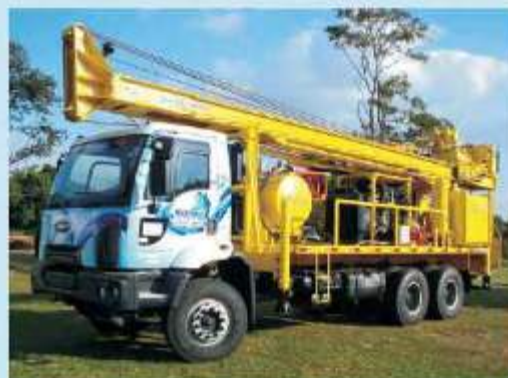
R-3H para perfuração até 1100 m R-3H para perforación hasta 1100 m
